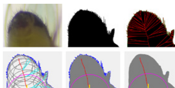
Рис. 6. Определение граничной линии брюшка на основе стрижки скелета и построения огибающей семейства вписанных окружностей.
